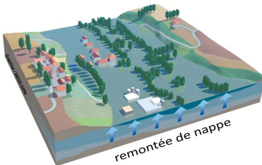
Figure 2 : Schéma d'une inondation par remontée de nappe phréatique [19].
